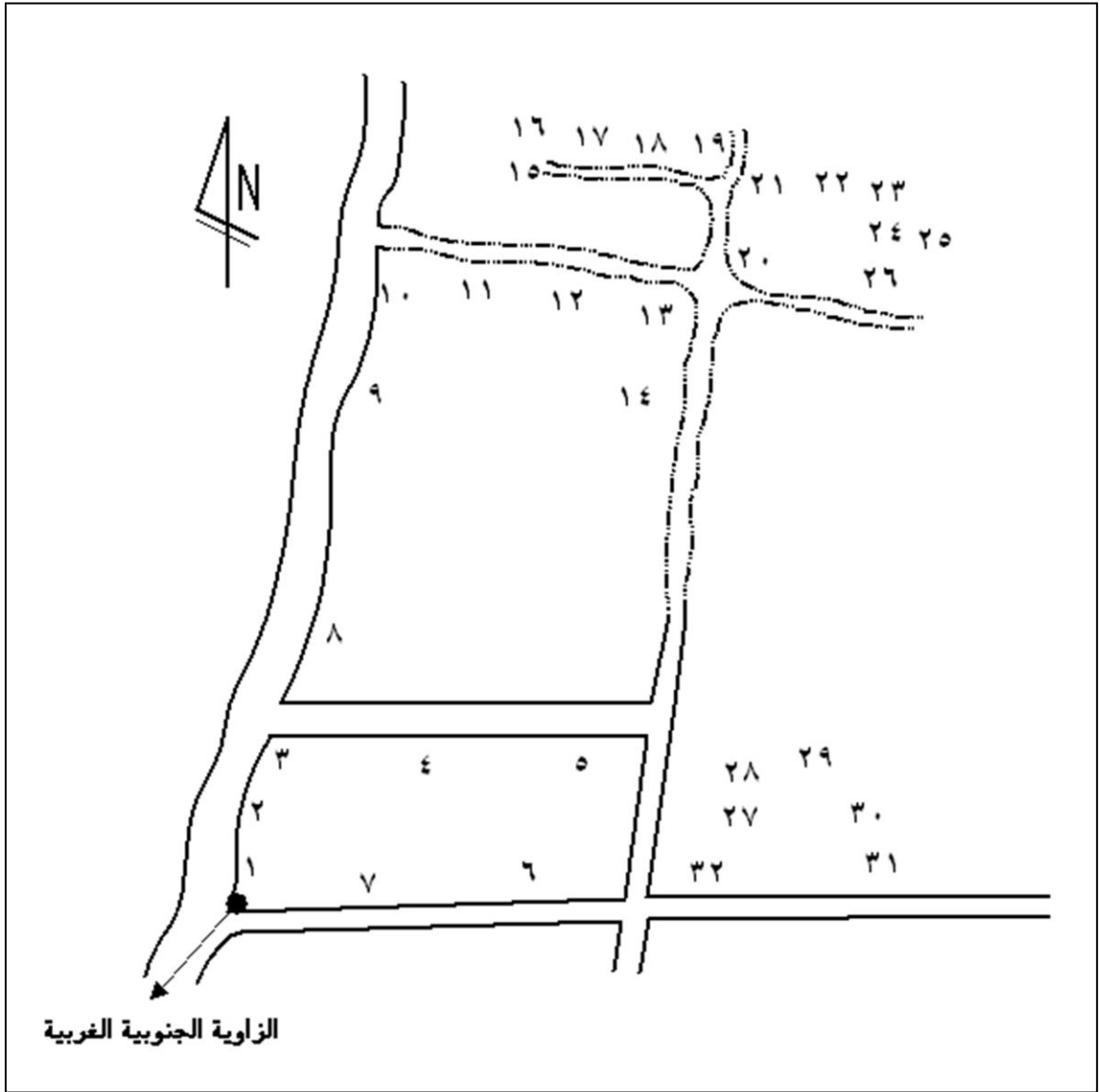
شكل 8: ترقيم المباني بإتباع أسلوب نظام القطع
